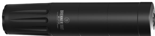
Overbarrel-Schalldämpfer Gewehre, M15x1, Durchmesser 40mm, Gesamtlänge 210mm, Laufverlängerung 130mm, -29dB Dämpfung, 332g
